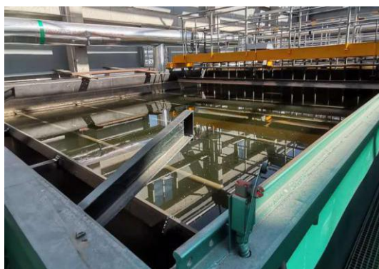
单晶硅含氟废水处理站
