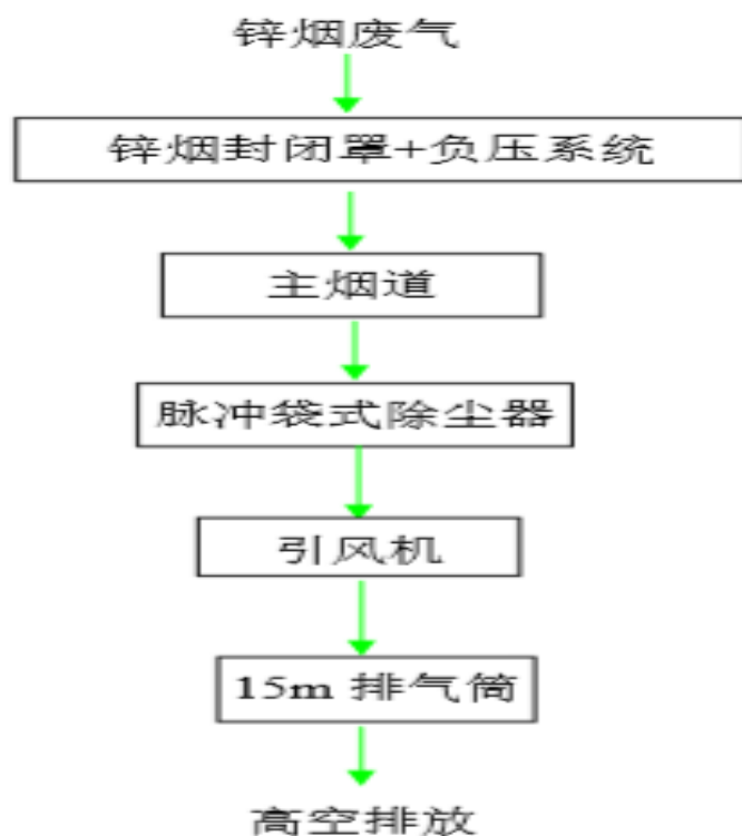
图 7.2-1 除尘器除尘工艺流程图
