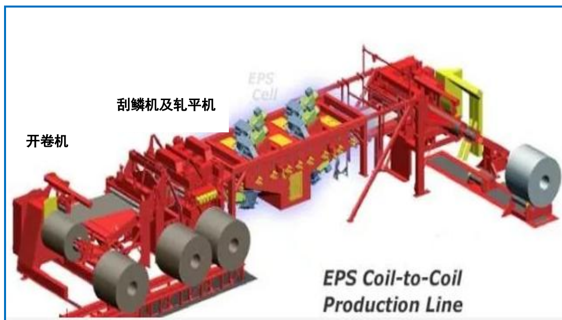
图 4.1-1 EPS 除鳞工艺流程图
