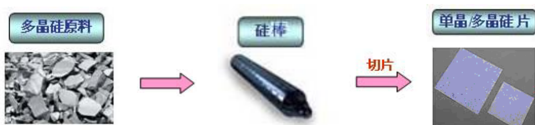
图 3-16 太阳能级单晶硅片生产过程图
